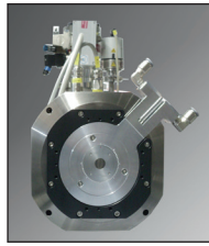
Röntgenröhre mit neuer Target-Halterung
